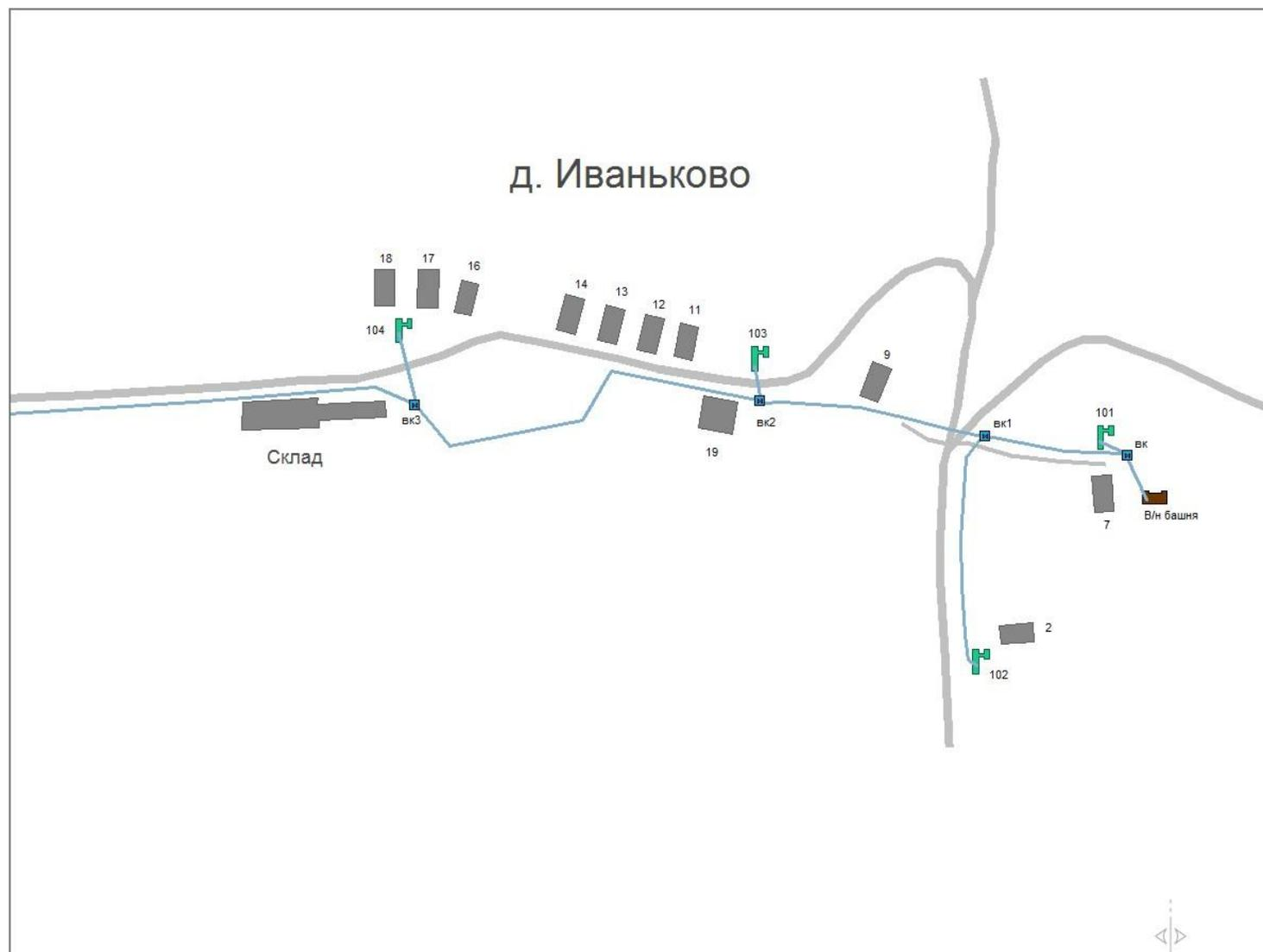
Рис. 5.11. Расчетная схема водоснабжения д. Иваньково Раменского сельского поселения
