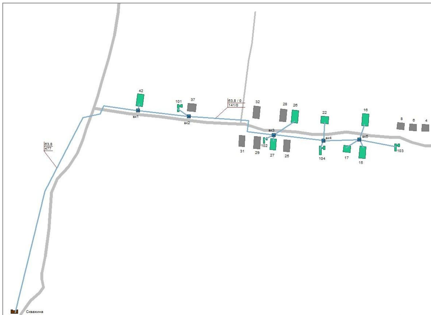
Рис. 5.8. Расчетная схема водоснабжения д. Костюхино Раменского сельского поселения
